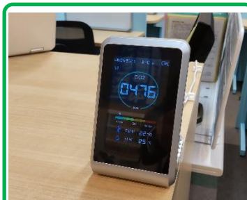
CO2 マネージャー(二酸化炭素濃度計)。校舎内の要所に設置しています!
